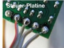
Dazu das Flachbandkabel abisolieren und die Enden verzinnen. Dann das Kabel an die Treiber Platine, wie im Bild zu sehen, anlöten. Das rote Kabel ist mit dem Anschluss IN1 verbunden. Dann die andere Seite des Flachbandkabels an die Steuer-Platine anlöten. Dabei kommt das rote Kabel an den Anschluss LSW auf der Steuer-Platine.
